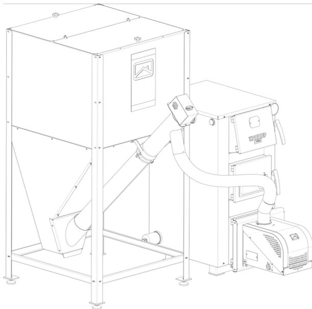
**Рисунок 1 - Схема установки ГПФ-26 (2.0) с бункером напольным на котел Куппер ПРО 22 (2018)**
